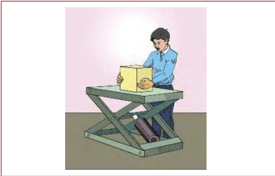
شکل ۲۶- استفاده از میز بالابر قیچی شکل قابل تنظیم جهت تنظیم ارتفاع کار
