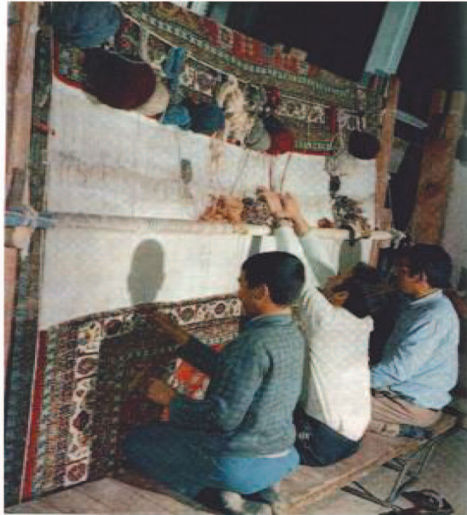
شکل ۵- دار عمودی با پایه های چوبی
