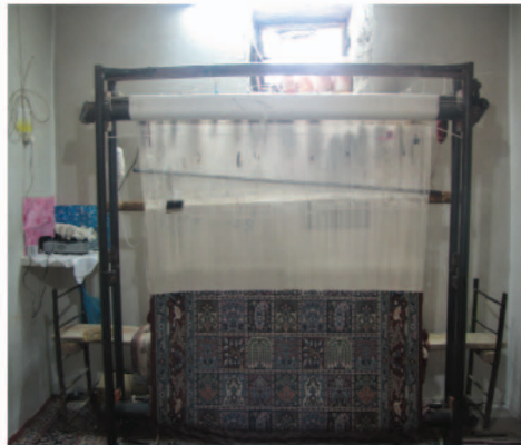
شکل ۳- دار قالیبافی-عمودی با پایه فلزی
